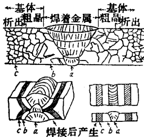
图10 18Cr-8Ni 钢的焊接热影响 (粗晶化及晶间析出)
