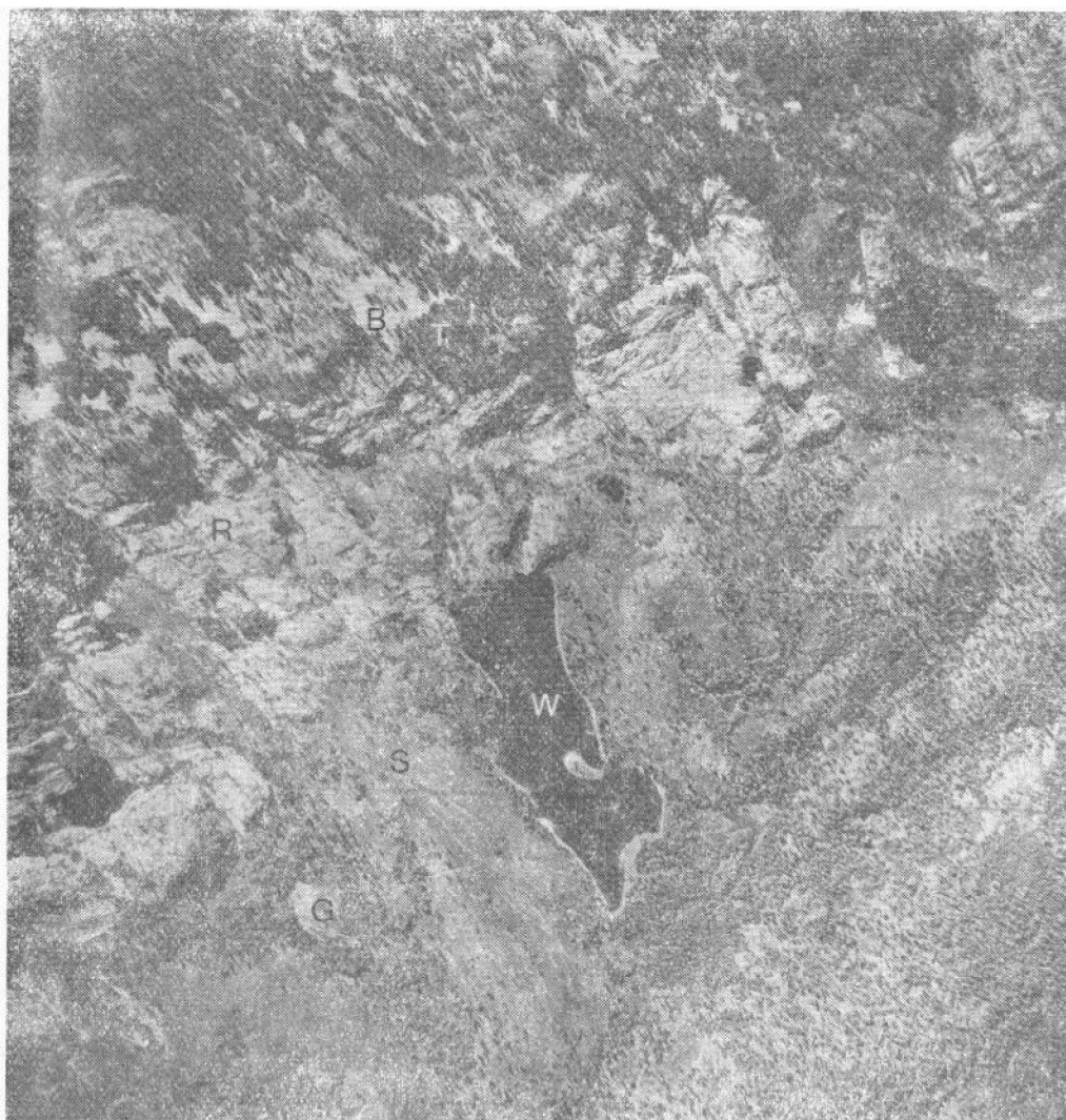
图1-1 按标准规范飞行拍摄的普通航空像片，使用全色胶片和“消蓝”（“minus blue”）滤光片（Wratten12），相机焦距长20厘米，底片尺寸为24×24厘米。整个像片的平均比例尺是 1:20000。这幅像片上标注符号的区域是：T = 树木，S = 灌木，G = 草地，R = 岩石，W = 水，B = 裸露土壤。
