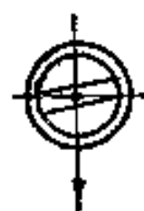
圖 14 用有洋鐵皮的木坑找正
