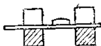
圖 9 不加工表面用精確度不高的方水平找平
