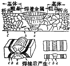
图10 18Cr-8Ni 鋼的焊接热影响 (粗晶化及晶間析出)
