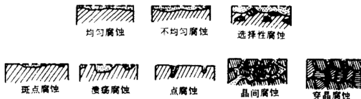
图 1-2 金属腐蚀的破坏形式
