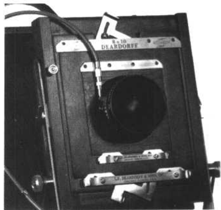
在镜头调节板上可装更小的镜头板, 从而在不同的画幅间实现镜头的互换。
