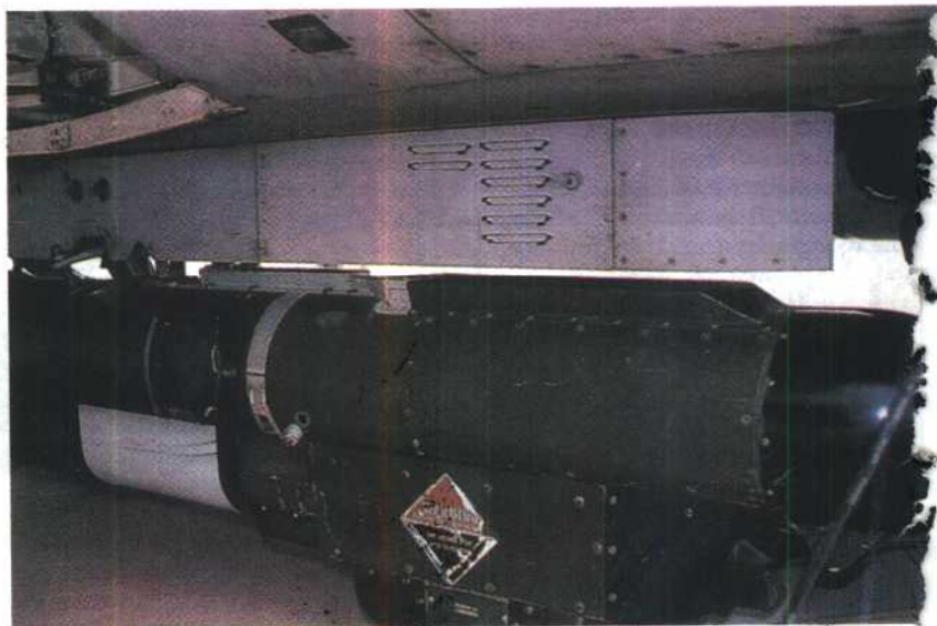
▲F-16机身上装有AN/ALQ-119自防护干扰吊舱
