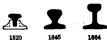
图 1-1-2 钢轨断面形状的演变
