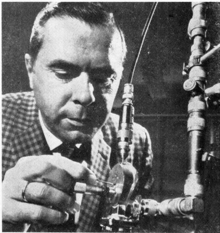
图1.1 科学家把一根顶部装有微小的耿氏效应振荡器的金属杆插入微波谐振腔内，用来产生实验性通信系统的几瓦的高频微波功率。
