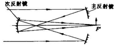
图 2-13 格里高利系统 1—次反射镜；2—主反射镜
