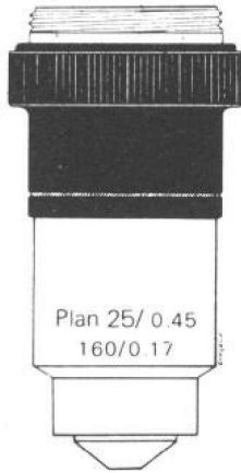
图 1 ~ 5 物镜的几项标记：放大倍数 \times 25 ， NA = 0.45 ，平面消色差的，校正为适用于 160mm 镜筒和 0.17mm 盖片
