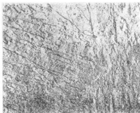
图 1-6 40Cr1250°C加热、1200°C锻造、 75%形变、840°C保温1小时淬水 10000×
