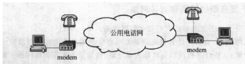
图 1.6 通过公用电话线路实现远程通信
