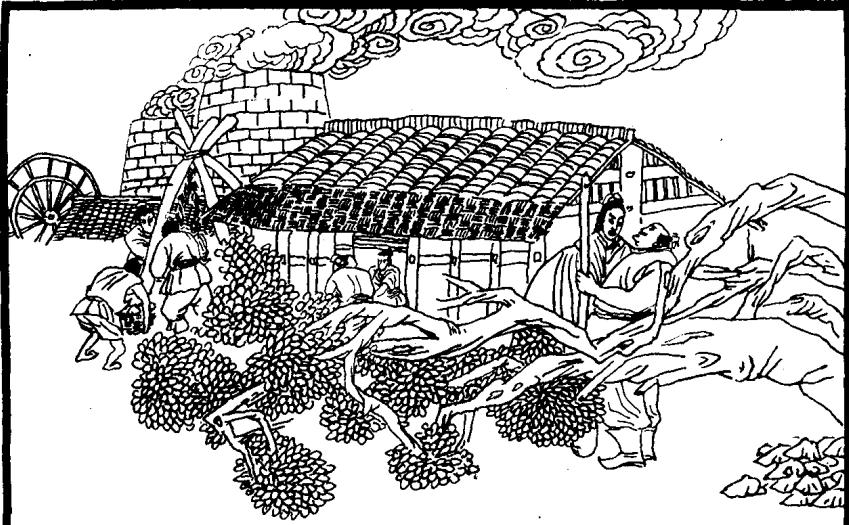
7. 南阳自古冶炼铁的技术就很有名。这时，南阳郡太守杜诗发明了“水排”，能够连续不断地提供有力的风力，克服了人力鼓风的不足，极大提高了冶铁的工效。
