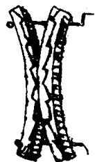
图18 两个相对的圆弧刀刃的拉刀
