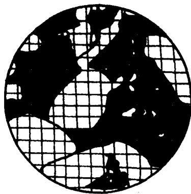
图 2—2 岩石薄片测量图示
