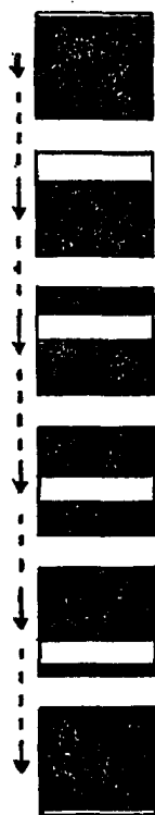
上：圖五 焦點平面快門之形狀。 右：圖六 焦點平面快門的縫隙通過非林表面之整個過程。
