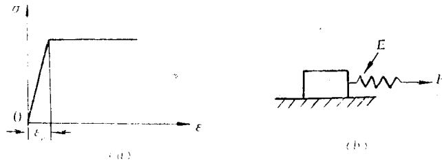
图 1.3 理想弹塑性材料应力应变曲线 (a) 及加载模型 (b)
