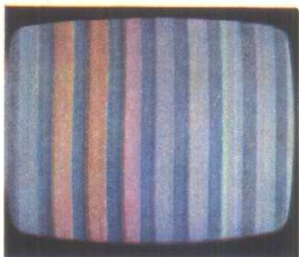
圖7-6 G-Y放大器集電極電路負載 電阻值偏低的情況
