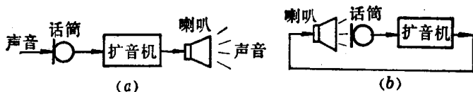
图 8-1-1 扩音机由正常扩音变成自激振荡
