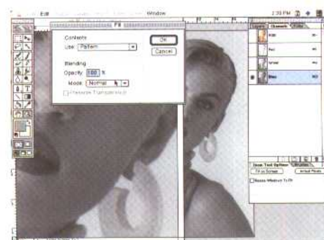
(16) 回到“修复 1”中，进入蓝色通道，选取 Edit/Fill Use:Pattern，将第 15 步储存的状态填充进去。
