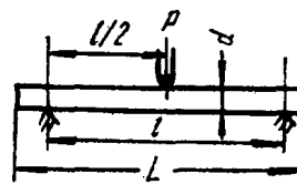
图 1-5 金属材料弯曲试验示意图 a) 塑性材料； b) 脆性材料
