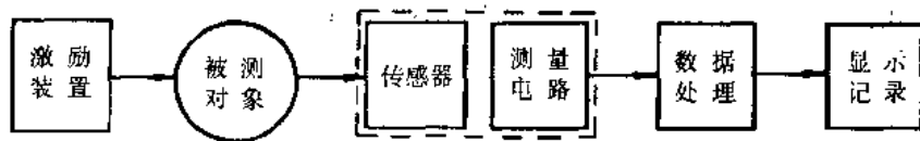
图 0-1 检测系统组成框图
