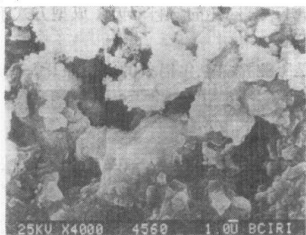
图 1-3 圆柱形条的内部孔结构
