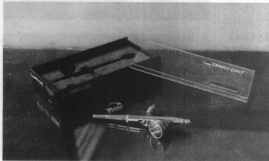
喷笔是利用空气压缩机喷出雾状的色粒进行作画，能产生极柔和的调子。喷笔的口径（喷嘴）一般使用 0.2 毫米即可（图 2）。
