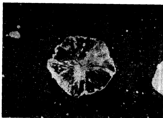
图5 \times 1000 未浸蚀球状石墨 (暗场照明)
