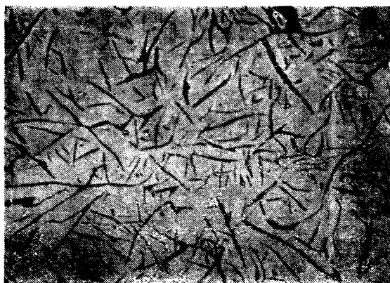
图26 \times 100 未浸蚀片状石墨，未球化
