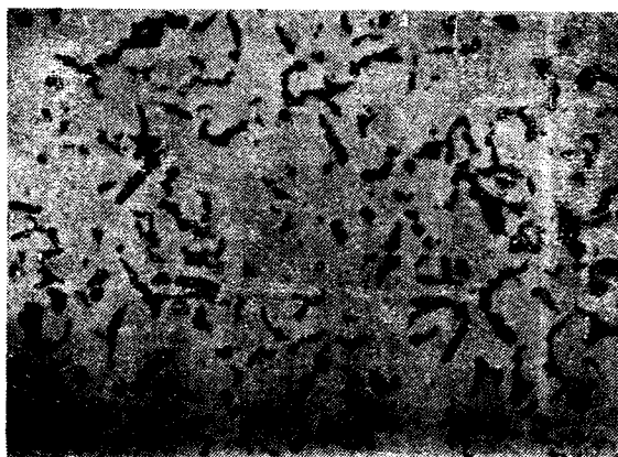
图25 \times 100 未浸蚀爪状及厚片状石墨，球化不良
