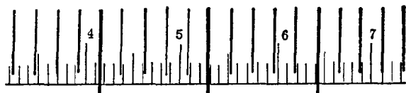
图 8 接目测微计刻度与镜台测微计刻度比较
