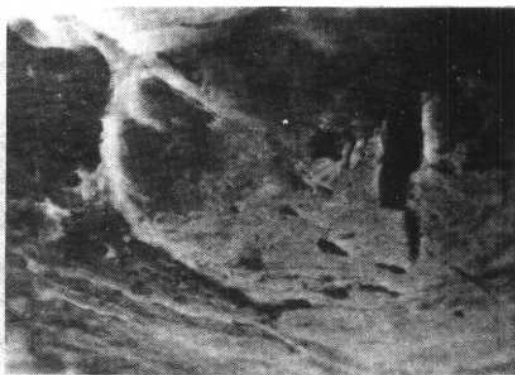
图 24 裂纹及空洞(斜截面样品) (扫描电子显微镜, 1400 \times )
