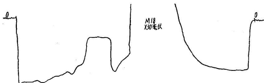
图2 去掉辅助磁铁, G_1 = -35\text{ V} , 用 M = 18 峰检查二次电子形成的负峰区
