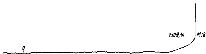
图12 入口狭缝带正压的双层狭缝单接收器，用 M=18 峰检查二次电子和“长尾”
