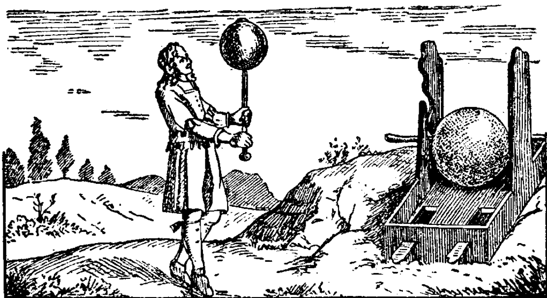
圖2. 奧托·戴里克起電用的硫黃球和機床。
