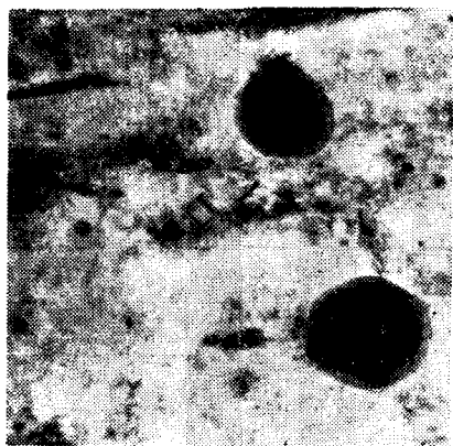
(a) 1050°C 正火后的薄膜衍衬图象 M_{23}C_6 (长条形) 和 TiC(球形) \times 36000
