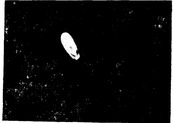
(b) 图(a)的 M_3B_2(021) 的暗场象 \times 36000
