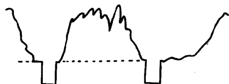
图1.2.5 行同步脉冲示意
