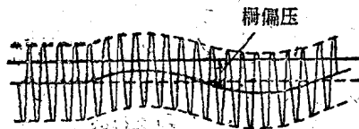
图 15-3 用固定偏压和栅漏偏压的板极调幅丙类放大器的波形图
