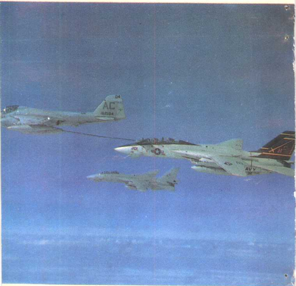
F-14“雄猫”舰载战斗机正在接受 KA-6D 加油机的加油。
