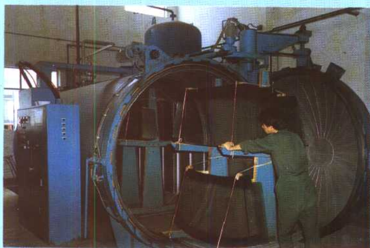
中外合资经营企业——杭州 安全玻璃厂工人正在为国产轿车桑 塔纳生产各种夹层挡风玻璃。
