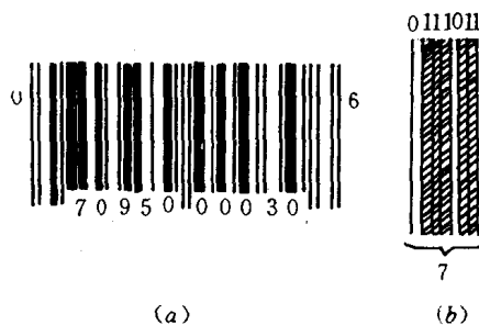
图 1.1.3 通用的商品条形码标志 (a) 条形码标志实例; (b) 7 的条形码
