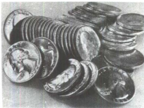
图2 包覆金属钱币和早期银币重量及电导率相同
