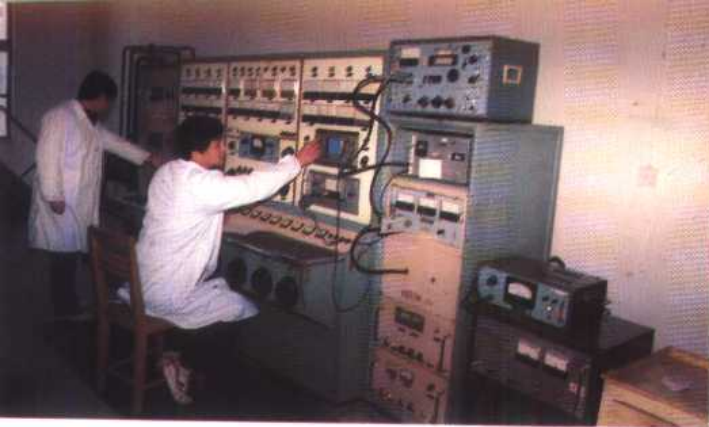
四四〇四厂大功率速调 管测试室
