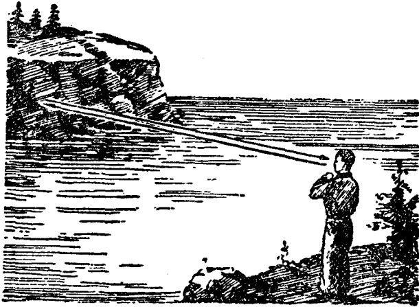
圖 1. 依靠回聲的幫助，可以測定距離。
