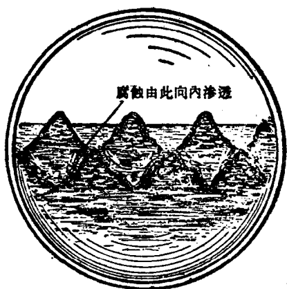
图 3 在腐蝕作用的影响下的表面被破坏的略图。
