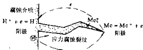
图 1-3 应力-阳极开裂示意图
