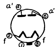
电极和管脚连接图
