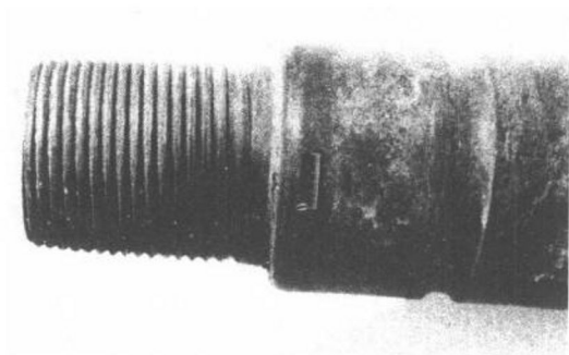
图 1-3 钻杆接头螺纹部分过量变形， 伸长 20.7mm
