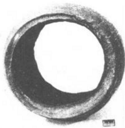
图 1-5 钻杆过载断裂 (断于焊缝热影响区)
