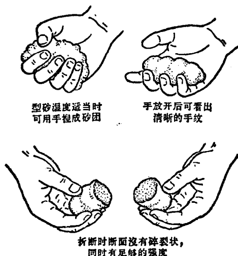
图 I-15 手捏法检验型(芯)砂
