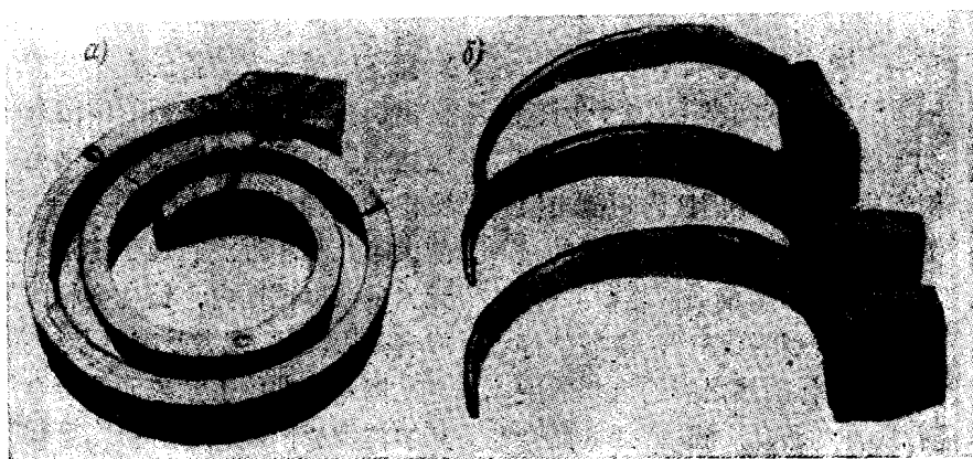
图 6 螺旋线试样的外形 a—窄结晶间隔合金; b—宽结晶间隔合金
