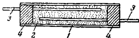
圖 1. 金屬屑檢波器的構造(上視圖)
