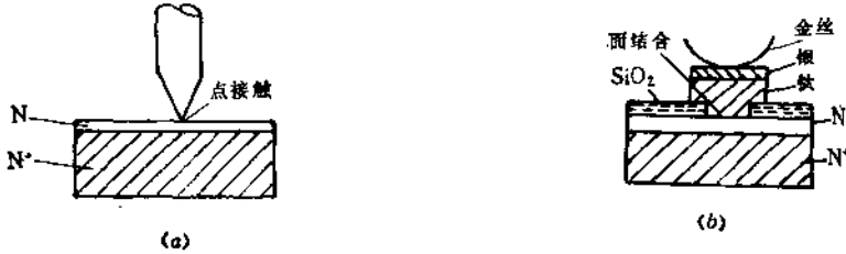
图1-2 金属-半导体结二极管的管芯结构 (a) 点接触型；(b) 面结合型。
