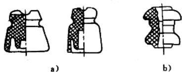
图1-1 低压架空线路用绝缘子 a) 低压针式绝缘子 b) 低压蝴蝶形绝缘子
