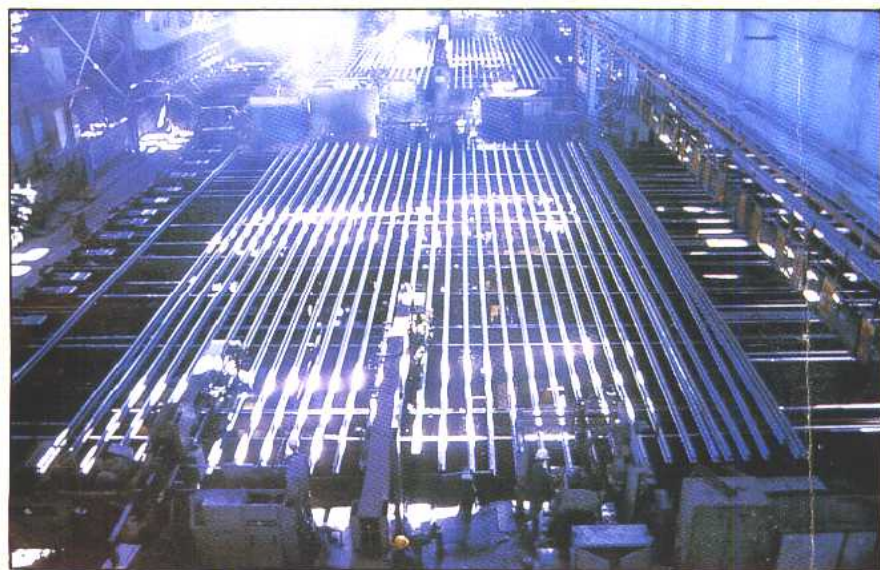
攀枝花钢铁公司轨梁厂钢轨加工线
