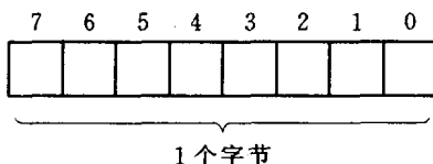
图1-2 一个存储单元的各位
